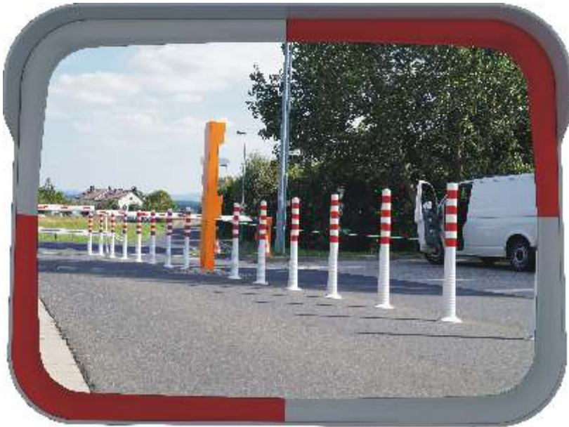
12246 RW Verkehrsspiegel rot-weiß, 80 x 60 cm, Acrylglasspiegel (d = 2 mm), Beobachtungsabstand 0 - 20 m Rahmen: ABS, Gelenkarm: Aluminium, Gewicht: 5,4 kg
