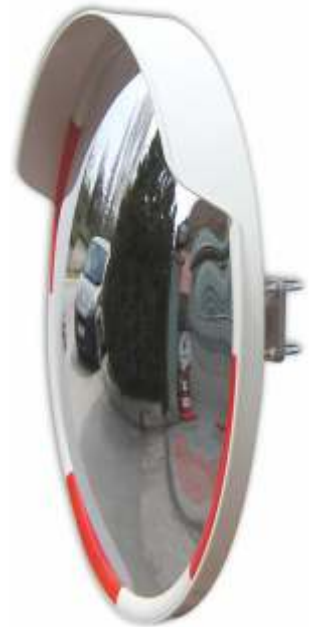
12229 RW Verkehrsspiegel rot-weiß, ø 60 cm Acrylglasspiegel, Beobachtungsabstand 0 - 15 m Rahmen: ABS, Gelenkarm: Aluminium, Gewicht: 4,0 kg
