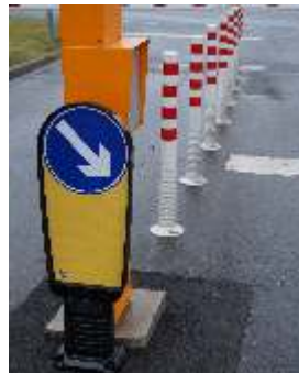
Flexibake orange 14256 BA rechtsweisend 14256 BL linksweisend (H) 750 mm, TPU, Breite 120 mm, 1,4 kg einseitig retroreflektierend ohne Befestigungsmaterial
