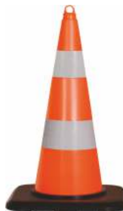
12315 ZR Leitkegel (H) 750 mm, PVC, 6,6 kg retroreflektierende Folie Klasse RA 2
