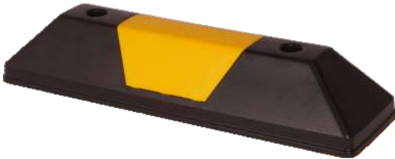
14261 SS Leitschwelle 0,55 m schwarz mit gelbem Einleger L x B x H: 550 x 155 x 100 mm, PPC 1,85 kg ohne Befestigungsmaterial
