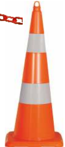
12325 ZR Leitkegel (H) 900 mm, PVC, 3,6 kg retroreflektierende Folie Klasse RA 2
