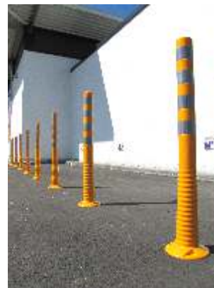
14242 FP Flexipfosten® gelb 3 retroreflektierende Streifen (H) 750 mm, TPU, ø 80 mm, 1,32 kg ohne Befestigungsmaterial
