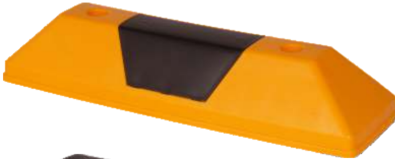
14261 GG Leitschwelle 0,55 m gelb mit schwarzem Einleger L x B x H: 550 x 155 x 100 mm, PPC 1,85 kg ohne Befestigungsmaterial
