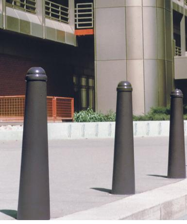
Der legendäre "Klassiker", nach dem heute eine ganze Pfostenart benannt wird. Wegen seiner schlichten zeitlosen Form einer der beliebtesten Poller. Die konische Form sorgt für sicheren Stand und ermöglicht einfache Montage. Er fügt sich gut in gepflasterte Flächen ein. Aufwendige, langlebige Qualität: Ein kräftiger Poller aus Gütestahl mit 3 mm Wandstärke. Bestmöglich korrosionsgeschützt: innen und außen feuerverzinkt. Zusätzlich antikbraun kunststoffbeschichtet (RAL 8019).
