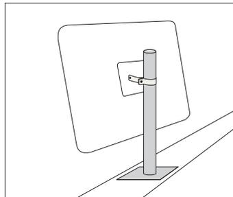
Zur Befestigung an waagerechten Flächen, z.B. Mauern, Decken etc.
