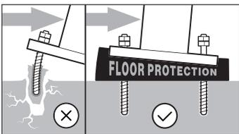
Die Standardausführung der Black Bull Rammschutz-Bügel wird mit zusätzlichen Polyurethan-Federelementen ausgerüstet. Das UV-beständige und dauerelastische PU-Element absorbiert die auf den Bügel wirkenden Kräfte.
