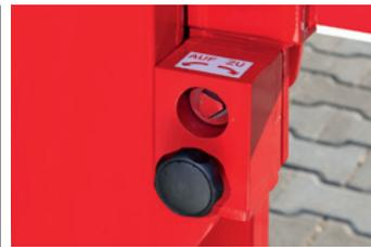
Der Verschlussbolzen der COMPACT Systemschranke rastet in offener und geschlossener Position automatisch ein. Abschließbar durch verschiedenschließenden Rundzylinder, einschließlich 2 Schlüssel. (Der Schlüssel lässt sich nur in eingerastetem Zustand abziehen.)
