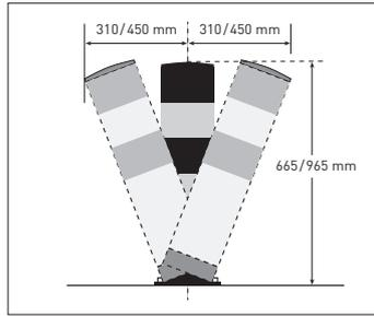
Die innenliegende Stahl-Spiralfeder absorbiert in Verbindung mit dem elastischen Puffer aus Polyurethan die auftretenden Anfahrkräfte (progressive Kraftaufnahme).
