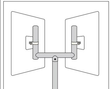
Zur gleichzeitigen Befestigung von 2 Spiegeln.
