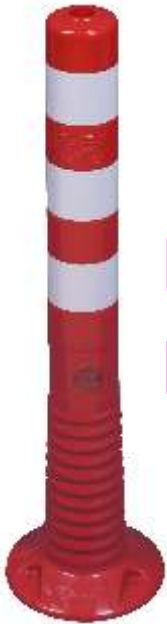
14212 RW Flexipfosten® rot 3 retroreflektierende Streifen (H) 750 mm, TPU, ø 80 mm, 1,32 kg ohne Befestigungsmaterial
