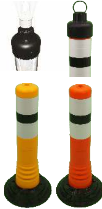
12234 KG Flexipfosten® gelb 12236 KO Flexipfosten® orange (H)450 mm, TPU, ø 80 mm, 1,10 kg retroreflektierende Streifen ORALITE® 5450 weiß Commercial Grade Class RA1 Design A Fuß ABS ø 200 mm zum Kleben
