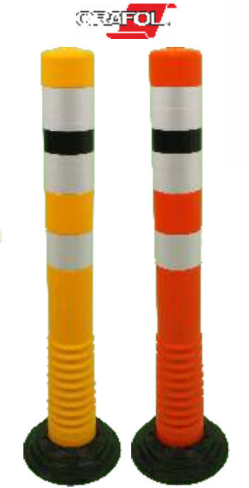
12230 KG Flexipfosten® gelb 12232 KO Flexipfosten® orange (H)750 mm, TPU, ø 80 mm, 1,46 kg retroreflektierende Streifen ORALITE® 5450 weiß Commercial Grade Class RA1 Design A Fuß ABS ø 200 mm zum Kleben
