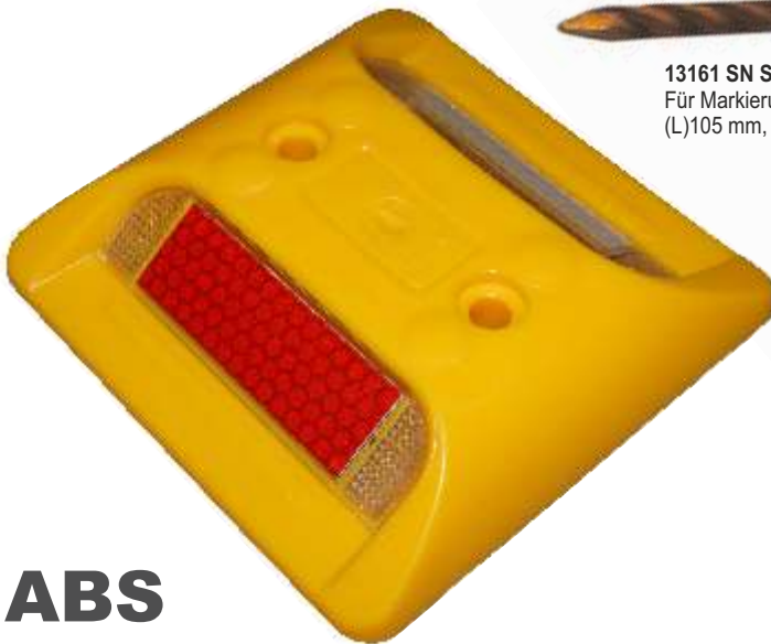
14005 MG Markierungsnagel gelb 2 Nagellöcher, ohne Befestigungsmaterial 105 x 105 x 20 mm, Material ABS 0,11 kg
