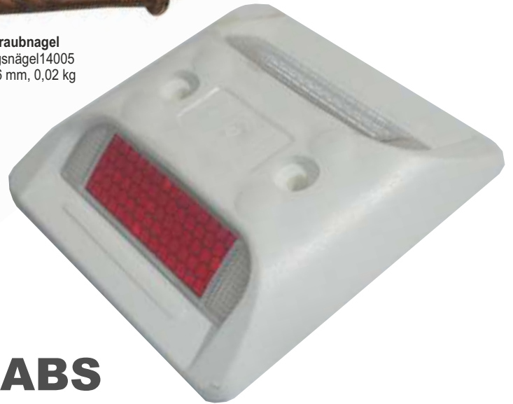
14005 MW Markierungsnagel weiß 2 Nagellöcher, ohne Befestigungsmaterial 105 x 105 x 20 mm, Material ABS 0,11 kg
