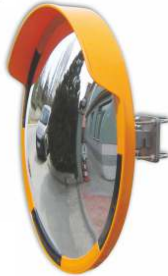
12228 SG Beobachtungsspiegel gelb-schwarz, ø 60 cm Acrylglaspiegel, Beobachtungsabstand 0 - 15 m Rahmen: ABS, Gelenkarm: Aluminium, Gewicht: 4,0 kg
