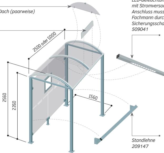
LED-Beleuchtung, mit Stromversorgung 220V. Der elektrische Anschluss muss von einem Fachmann durchgeführt werden. Sicherungsschalter nicht inbegriffen.
